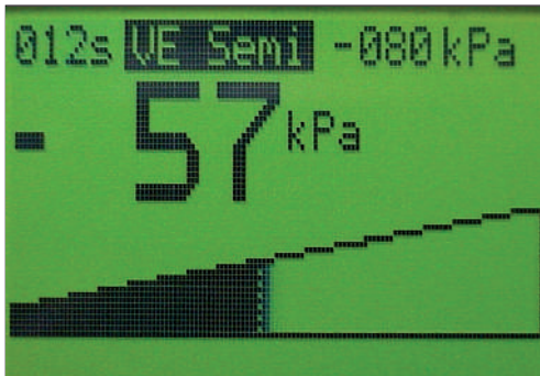
Bild 26. Automatischer Vakuumbau im VE- Semi Mode
