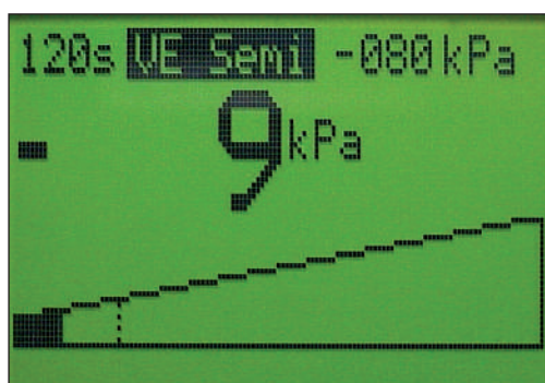
Bild 20. VE Semi Menü. Der Sauger versucht ein Grundvakuum von -20kPa aufzubauen.
