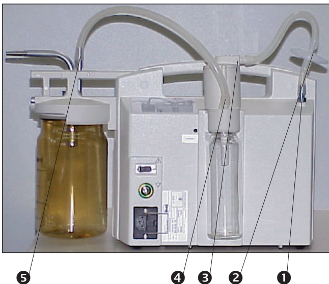
Bild 8b. Verschlauchung für Absaug-Modus
